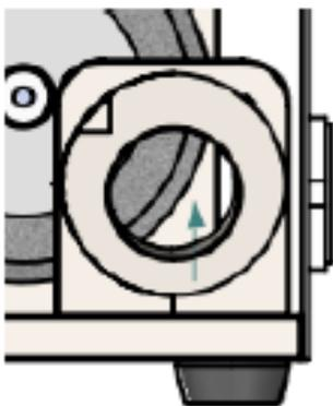
Надавить на крепежное приспособление с настроенным инструментом внутрь по направлению патрона, выполнить заточку до полного отсутствия звука, затем изменить угол и завершить заточку.
