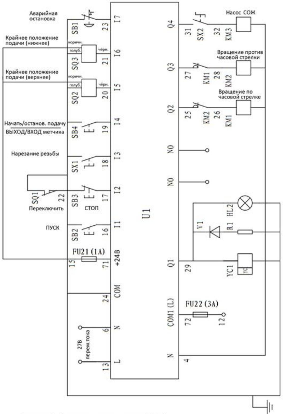
Внимание: Необозначенные сечения проводов 0.75мм<sup>2</sup>.
